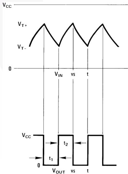
$$t_1 \approx RC \ln \frac{V_{T+}}{V_{T-}}$$
