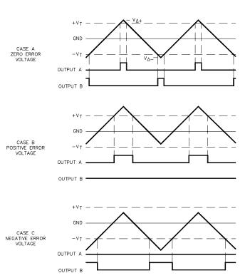
FIGURE 2 - PULSE WIDTH MODULATION WITH NO DEADBAND
